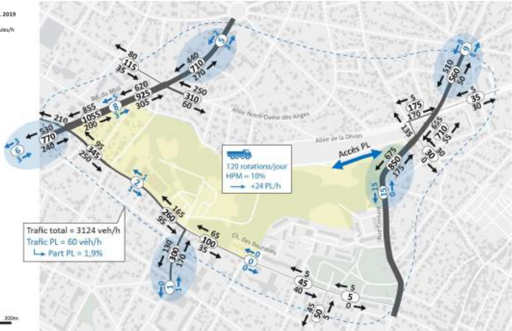
Simulation des flux camions en phase comblement des carrières en heures de pointe du matin
